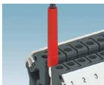
TPS... test soketleri köprüleme kanalına vidalanarak 2.3 mm ve 4 mm test fisileri için güvenilir test noktaları oluşturur. 2.3 mm MPS ... test fisi 5.2 ve 6.2 mm genişlikteki klemenslerle kullanıldığında köprüleme kanalına doğrudan takılabilir.
