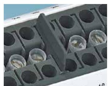
TS-TB izolasyon plakası komşu köprüleri elektriksel ve görsel olarak ayırmak için kullanılır. Klemensleri nominal gerilimlerinde kullanılmamak için bu parçalardan köprünün her iki tarafında kullanılmalıdır.
