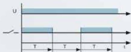
Çok fonksiyonlu zaman modülü, röle modülünü zaman rölesine dönüştürür. 24 V RIF-1/2/3/4 tabanları bu modülle kullanılabilir. 3 farklı zaman fonksiyonu 0,5 saniye - 100 dakika arasında kullanılabilir.
