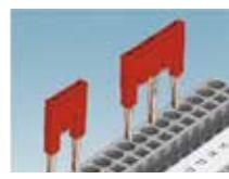
Komşu olmayan klemensler standart köprünün kutup bacakları kırılarak köprülenebilir. Bu şekilde iki farklı potansiyel, klemens dizisi boyunca paralel olarak taşınabilir. Kontak noktaları işaretlenerek belirgin hale getirilebilir.
