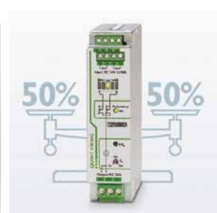
Güç kaynaklarının sekonder gerilimleri farklı olsa bile eşit yük akımıyla yükü beslerler. Geleneksel diyon modüllerinde olduğu gibi güç kaynaklarından birinin sekonderinde kısa devre oluşsa bile kumanda geriliminin stabil kalmasını sağlarlar. QUINT ORING Yedekleme Modülü diyon modüllerine göre % 70'e varan enerji tasarrufu sağlarlar.
