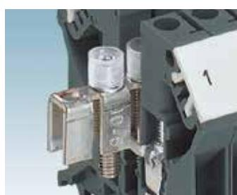
Köprüleme için 10 kutuplu SCBI... sabit köprü istenen kutup sayısında kesilerek köprü kanalına yerleştirilir ve vidalanır.
