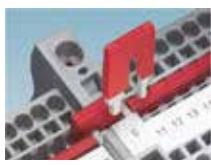
İndirici köprü farklı kesitteki klemenslerin köprülenmesini sağlar. Güç blokları indirici köprüyle hızlı şekilde düzenlenebilir, ö: ST 10 yaylı klemensi ST 2,5 veya ST 4 ile köprülenebilir.
