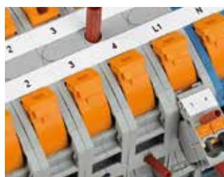
2,3 mm çaplı standart test fisleri için her iki tarafta test bağlantıları. Ayrıca, 4 mm test fisleri için klemens merkezinde 4 mm test bağlantısı olan yüksek akım klemensleri mevcuttur.
