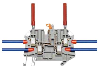
... P/P tipinde klemenslerin vidaları soket yapısına sahiptir. Bu sayede 2,3 mm çapında test fisinin bağlantısına imkan tanırlar.
